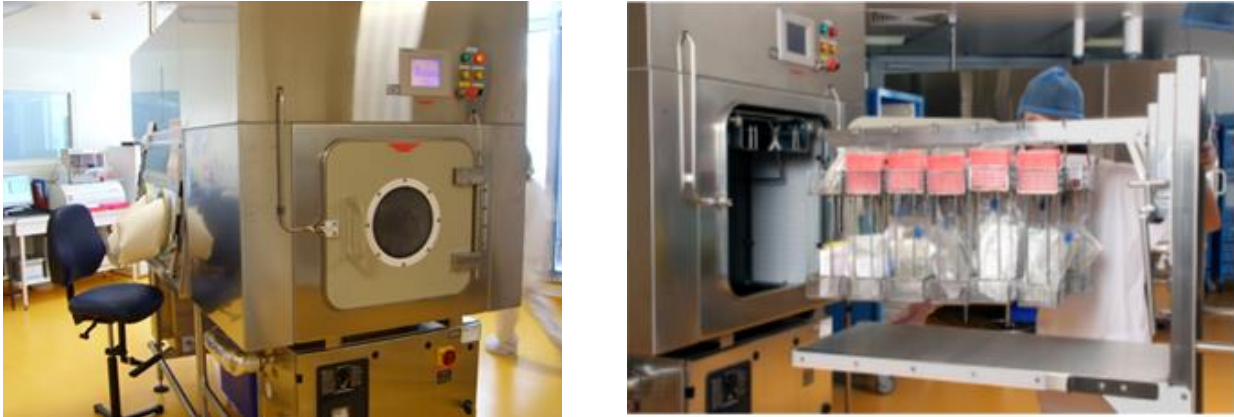
Figure 1. Isolateur (à gauche) et partie stérilisateur avec les paniers (à droite)
