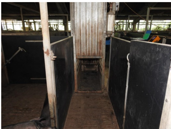
Photo 6. Entrée de la cage de pesée, porte levée
