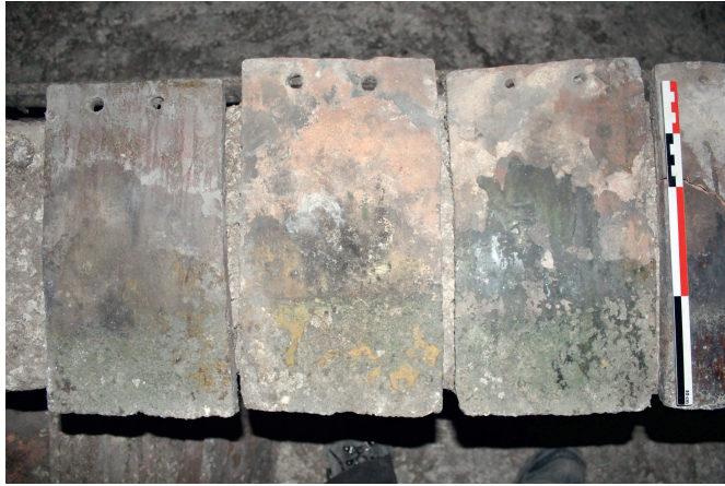
Fig. 11 Nef : tuiles médiévales retrouvées sur les reins de voûtes, type sans crochet à pureau glaçuré (cl. S. Aumard).
