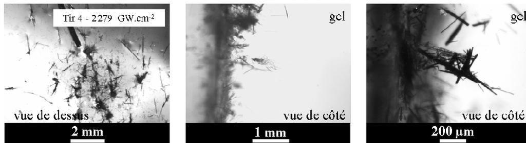
Fig. 5. Vues microscopiques au travers d'un collecteur en Varagel des fibres éjectées issues d'une cible de composite 4 plis choquée à  $2279 \text{ GW.cm}^{-2}$  (Tir 4). Sur les vues de côté, l'entrée des fragments est observée de la gauche vers la droite au travers du collecteur, la zone plus claire correspondant au gel.
