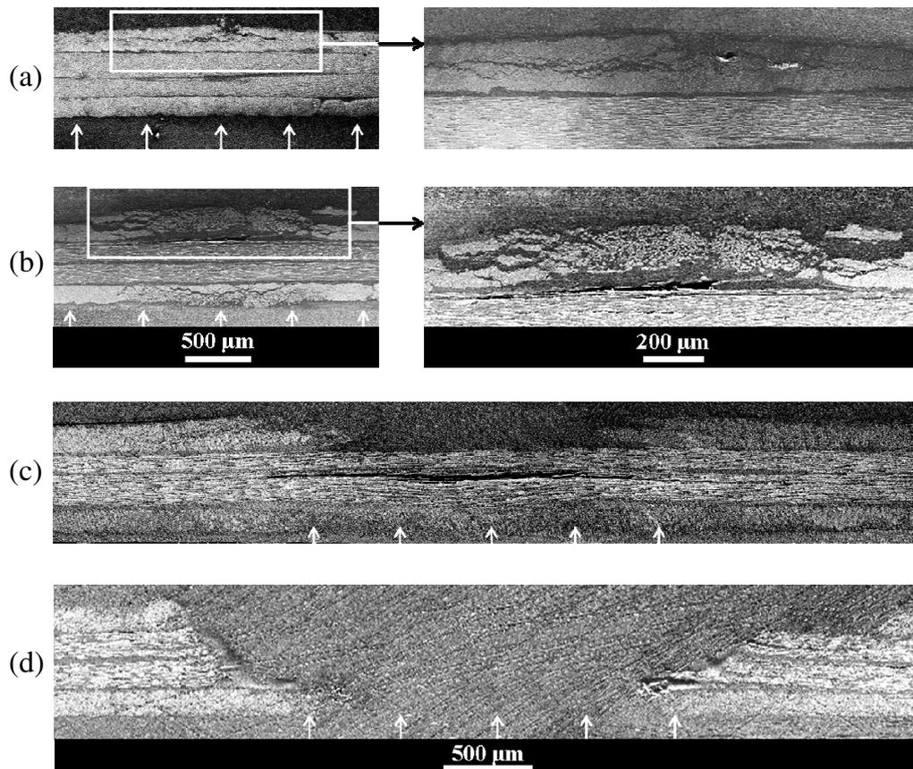
**Fig. 8. Microscopies en vue de coupe de composites 4 plis soumis à un choc d'intensité croissante :** (a)  $107 \text{ GW.cm}^{-2}$  (Tir 1), (b)  $1340 \text{ GW.cm}^{-2}$  (Tir 2), (c)  $2279 \text{ GW.cm}^{-2}$  (Tir 4), (d)  $7082 \text{ GW.cm}^{-2}$  (Tir 5). La zone d'irradiation sur la face incidente est matérialisée par les flèches blanches au bas des prises de vue.
