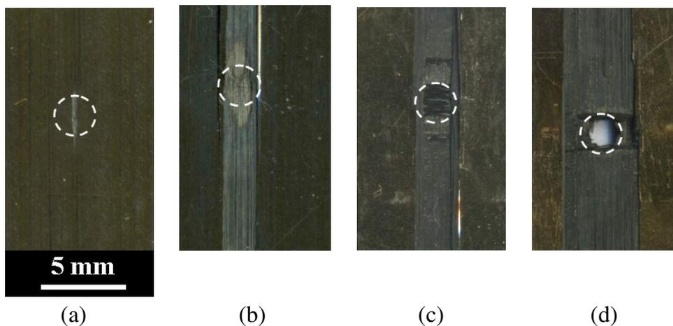
Fig. 6. Macrographies de la face opposée au choc d'échantillons composites 4 plis soumis à une irradiation de : (a) 107  $\text{GW.cm}^{-2}$  (Tir 1), (b) 1340  $\text{GW.cm}^{-2}$  (Tir 2), (c) 2279  $\text{GW.cm}^{-2}$  (Tir 4), et (d) 7082  $\text{GW.cm}^{-2}$  (Tir 5). La zone d'irradiation sur la face incidente non visualisée est délimitée par les cercles pointillés blancs.
