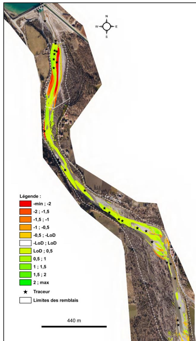
Figure 2 : Topographie différentielle du Buëch qui a permis de reconstruire les effets morphologiques de la réinjection sédimentaire en aval du barrage de Saint-Sauveur, suite à la crue de novembre 2016 (période de retour 5 ans). Le seuil de détection des changements est de 0.129 cm (intervalle de confiance de 95 %).
