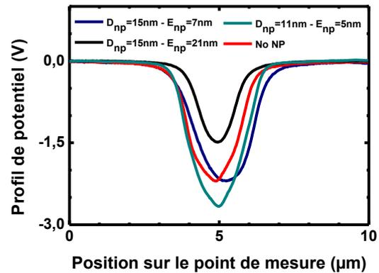
Fig. 2. Profil de potentiel mesuré par AM-KPFM après 1 min d'injection à -40V.
