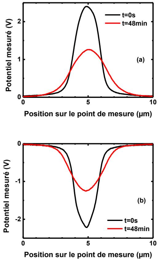
Fig. 5. Potentiel mesuré à  $t=0s$  et  $t=48min$  pour une tension d'injection de (a) +40V et (b) -40V sur l'échantillon S4b.
