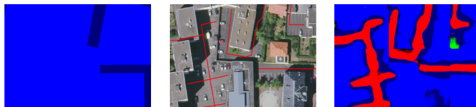
FIGURE 5. Biais sur la classification des routes entre la carte adaptée manuellement (gauche), l'orthophoto enrichie (centre) et le résultat généré par le réseau entraîné avec les données OSM (droite)
