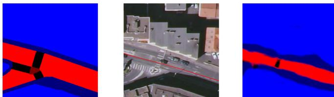
FIGURE 6. Erreur issue d'erreur de données OSM sur la classification. Référence (gauche), orthophoto avec données OSM incomplètes (centre), résultat du réseau entraîné avec enrichissement (droite)
