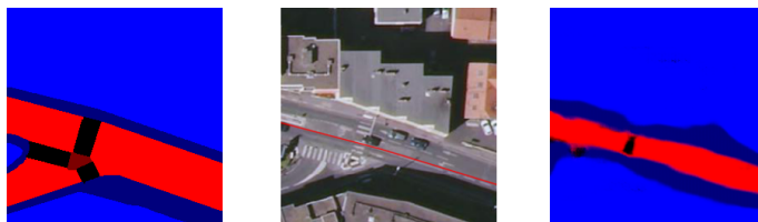
FIGURE 6. Erreur issue d'erreur de données OSM sur la classification. Réf rence (gauche), orthophoto avec donn es OSM incompl tes (centre), r sultat du r seau entra n  avec enrichissement (droite)
