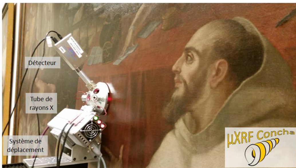
Figure 9 : Vue générale du dispositif \mu XRF-CONCHA durant l'analyse in situ du tableau intitulé "San Pedro Nolasco despidiéndose de Jaime I El Conquistador" (© Universidad de Sevilla, K. Laclavetine)
