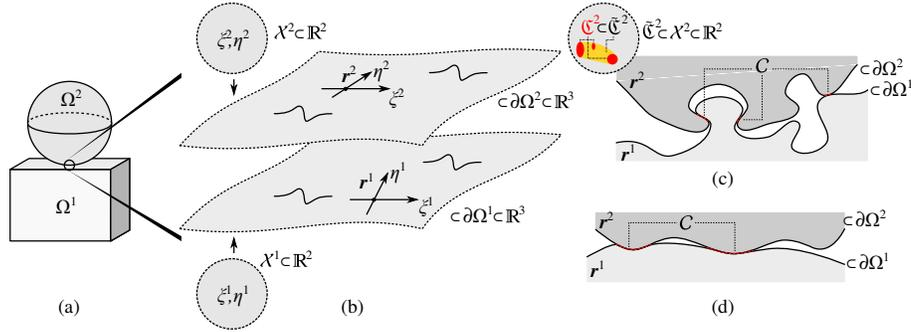
**Figure 1.1.** Problème du contact entre deux corps à surface : (a) l'échelle macroscopique, (b) zoom sur des parties des surfaces potentiellement en contact (la paramétrisation est indiquée), (c) exemple du problème de contact non-simplifiable, (d) exemple des surfaces qui permettent à l'instant donné une représentation explicite.
