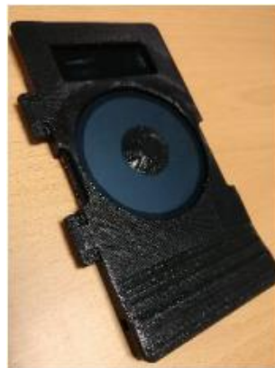
Figure 5: L'interface tactile avec le cache pour retour haptique passif
