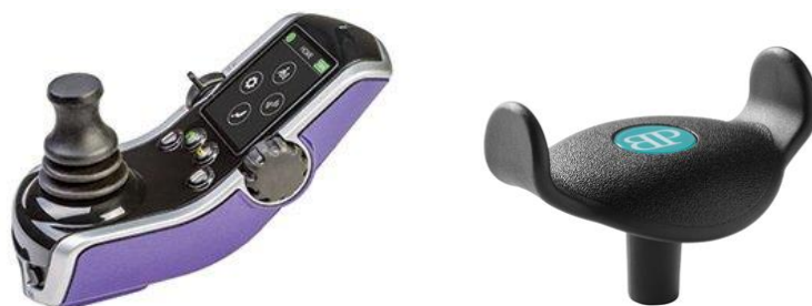
Figure 8 Gauche : un des joysticks utilisés par les participants du test 6 , Droite : levier de joystick en forme de U 7 utilisé par P11
