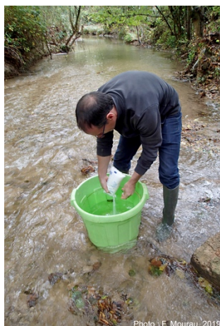
Figure 4 : La saumure doit être rigoureusement préparée avec l'eau de la rivière. C'est une étape importante pour réussir le jaugeage car on doit veiller à dissoudre intégralement la masse de sel sans en perdre en réalisant le mélange.
