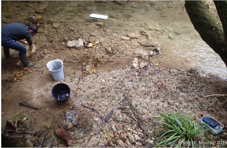
Figure 6 : Avant le prélèvement, les seaux doivent être nettoyés puis bien vidés et séchés. Il faut bien anticiper la taille des récipients à utiliser : la mesure peut durer plus de 15 minutes, avec un prélèvement toutes les 5 secondes, il ne faut pas que le volume prélevé dépasse celui du seau.
