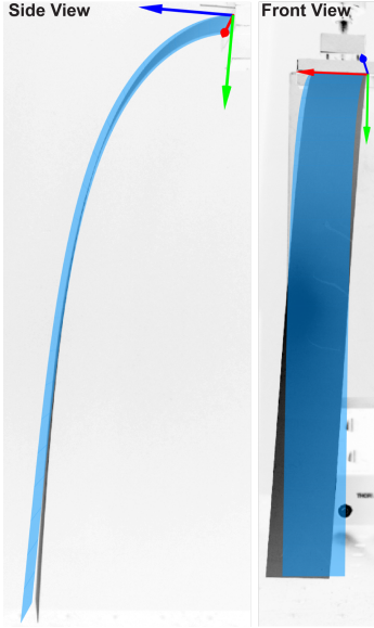
Figure 8 : Expérience de la poutre console : le ruban expérimental (en gris foncé) est fixé horizontalement d'un côté et tombe sous son propre poids. La prédiction de notre modèle (en bleu) est projetée sur l'image réelle pour comparaison. Le ruban réel est découpé dans une feuille de PET (Polyethylene terephthalate), avec comme dimensions 29cm × 3cm × 0.143mm.
