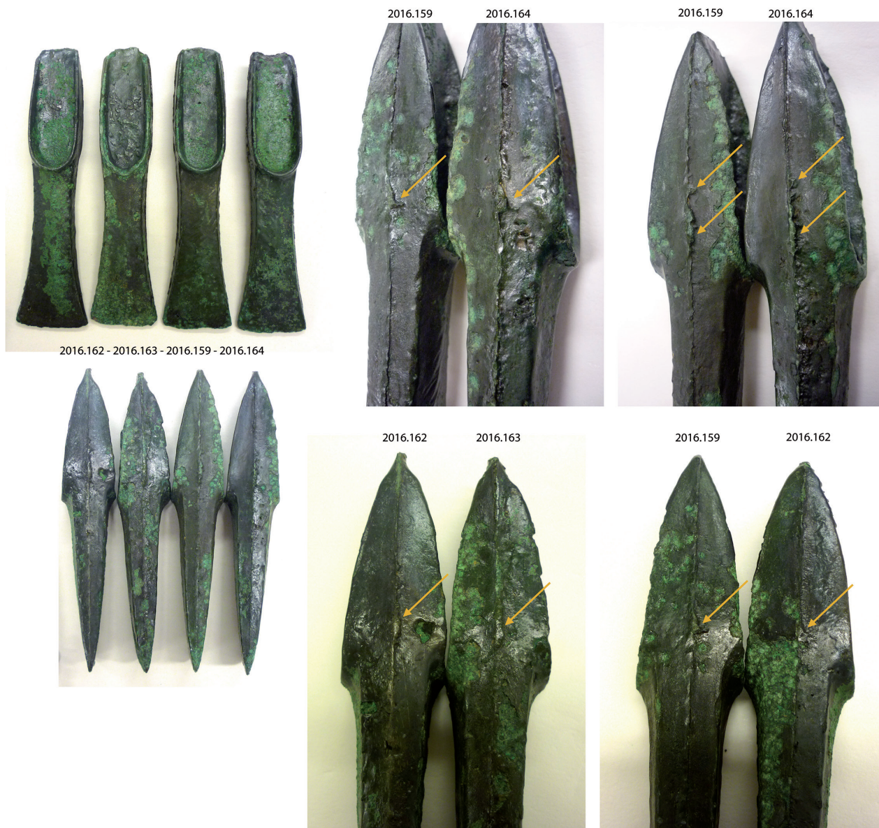
Fig. 22 – Quatre haches issues d'un même moule, comme le démontrent plusieurs petits défauts qui se répètent d'une hache à l'autre (flèches ; photos M. Mélin).
