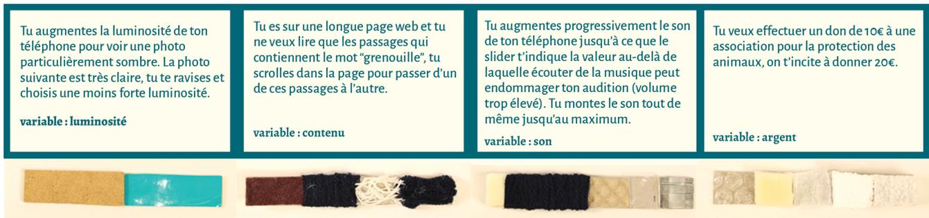
Figure 1: Prototypes basse fidélité de variateurs linéaires donnant une information tactile aux utilisateurs. Ces prototypes ont été réalisés par les participants de la 2<sup>nde</sup> expérience, et correspondent aux scénarii présentés au-dessus.
