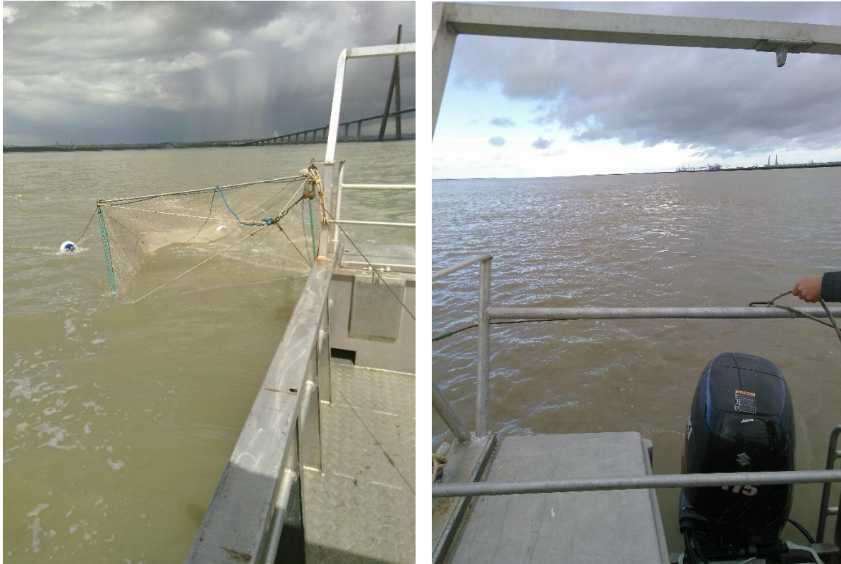
Photo 6 : Filet de prélèvement des macroplastiques tracté par le bateau de la société PRELEVMAR.
