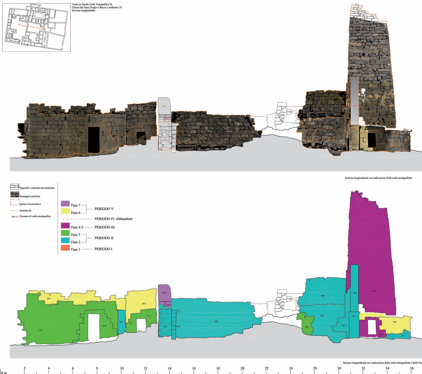
Fig. 28. Sezione longitudinale della chiesa dei santi Sergio e Bacco e di parte della corte occidentale (I) con indicazione delle US e delle Fasi
