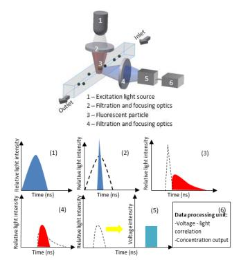
Fig. 6. General fluorescence detection scheme (orthogonal).
