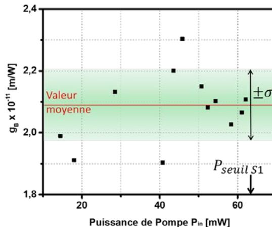
Fig. 2 : Valeurs de gain obtenues pour différentes puissances incidentes de pompe par la méthode CRDM.
