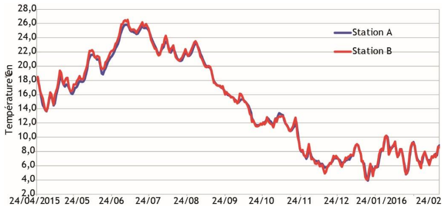
529 530 Figure 12 : Evolution des températures moyennes journalières en surface de la retenue au 531 droit des stations A et B
