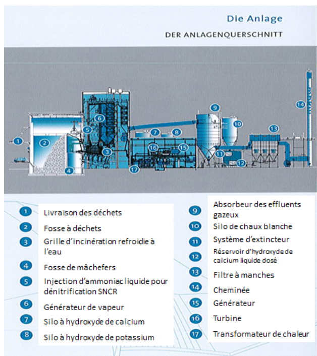
Photo 2. Le processus industriel d'incinération
