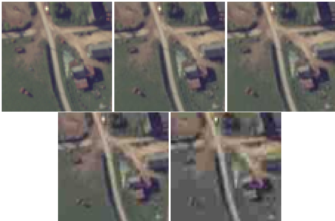
FIGURE 4 – Jeu de données “aérien” : De gauche à droite, extrait de l'image originale et des images compressées de qualité 85%, 50%, 25% et 10%
