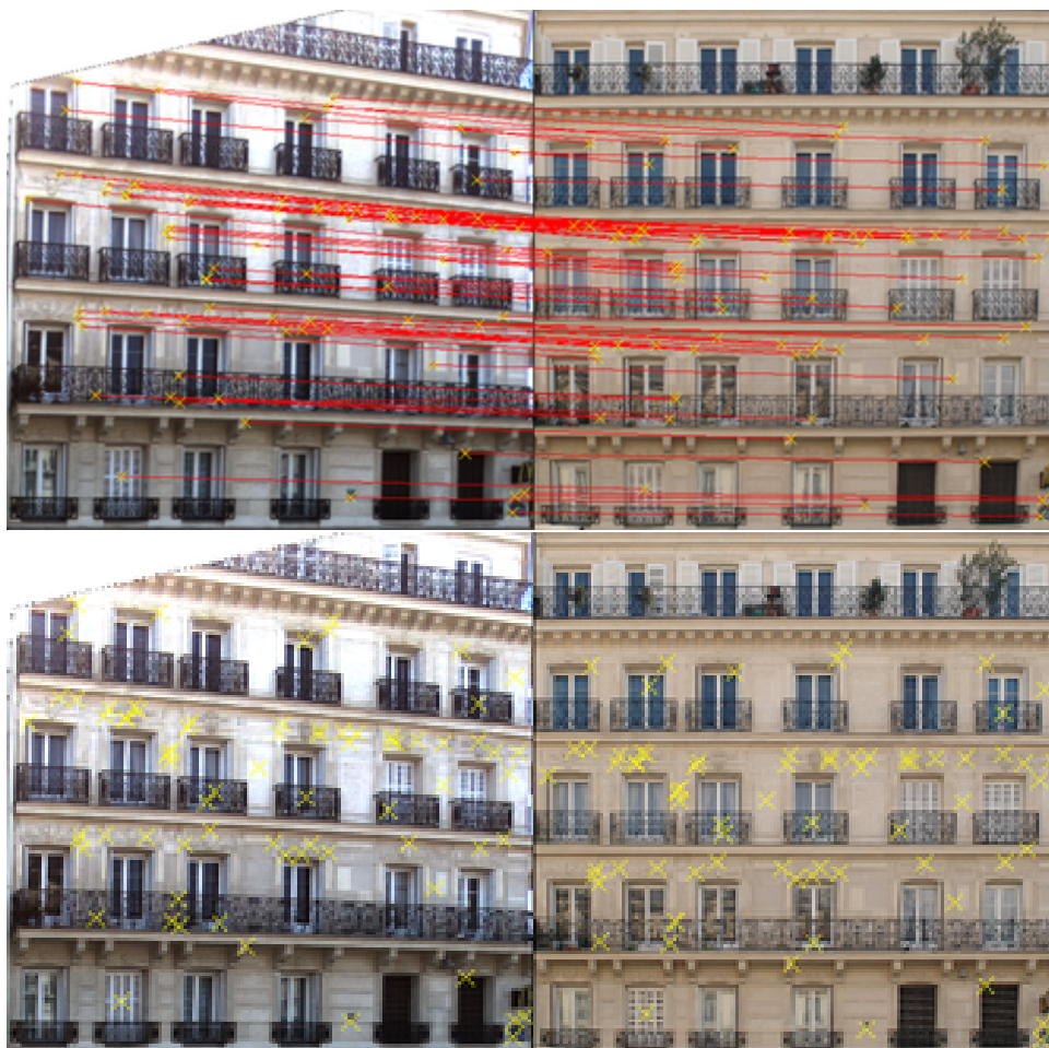
FIGURE 122 – Appariements bruts entre images redressées (à gauche : véhicule / à droite : piéton)
