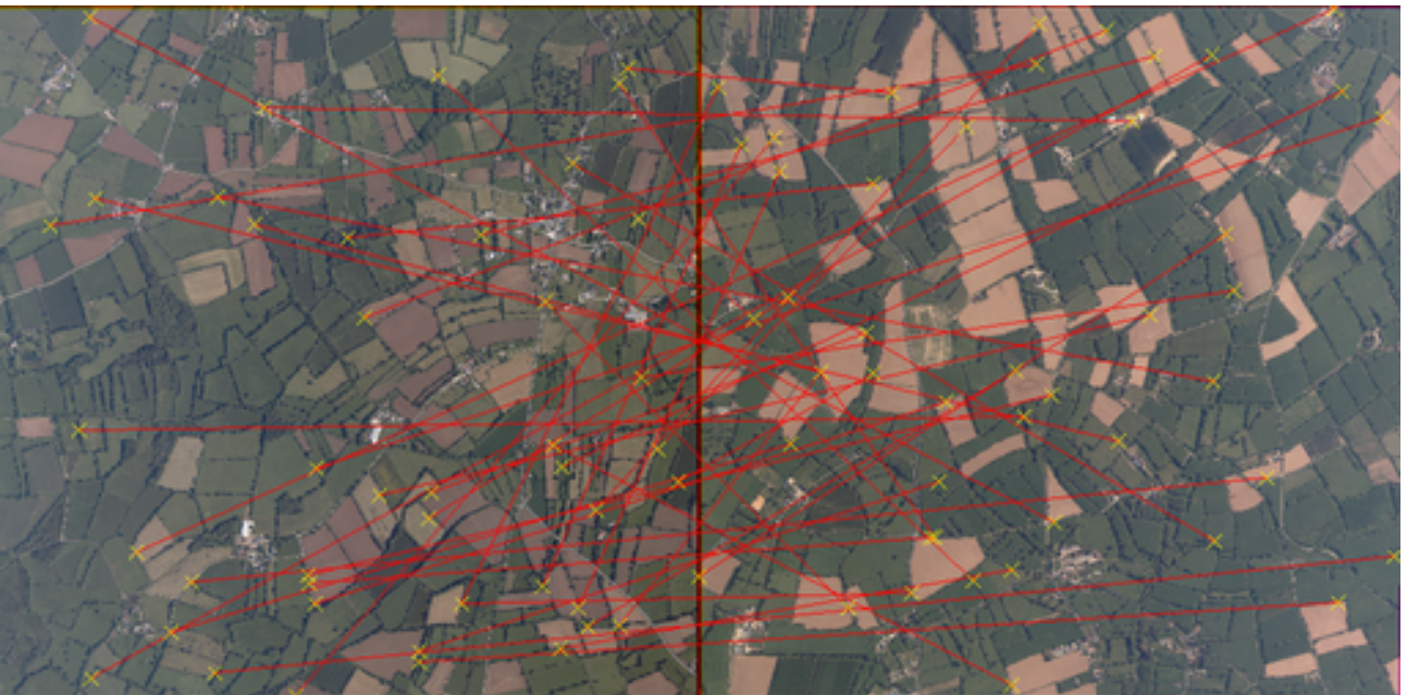
FIGURE 61 – Exemple d'appariements obtenus entre deux images en interbande dans un cas de fort diachronisme : les fautes sont suffisamment importantes pour qu'il soit possible de s'en rendre compte
