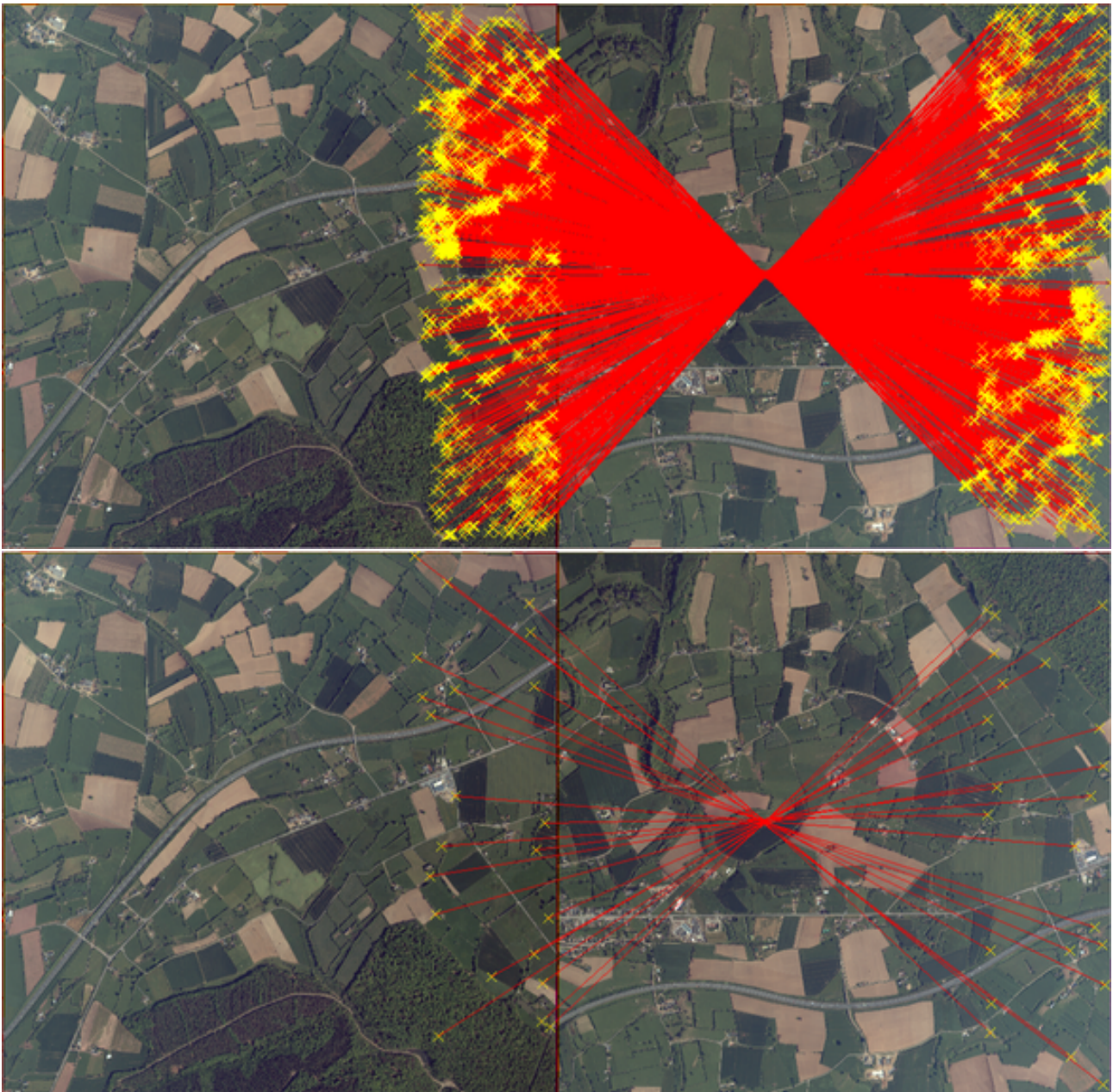
FIGURE 59 – Exemple d'appariements entre deux images en interbande (avant et après sélection d'un nombre limité de points pour l'aérotriangulation)
