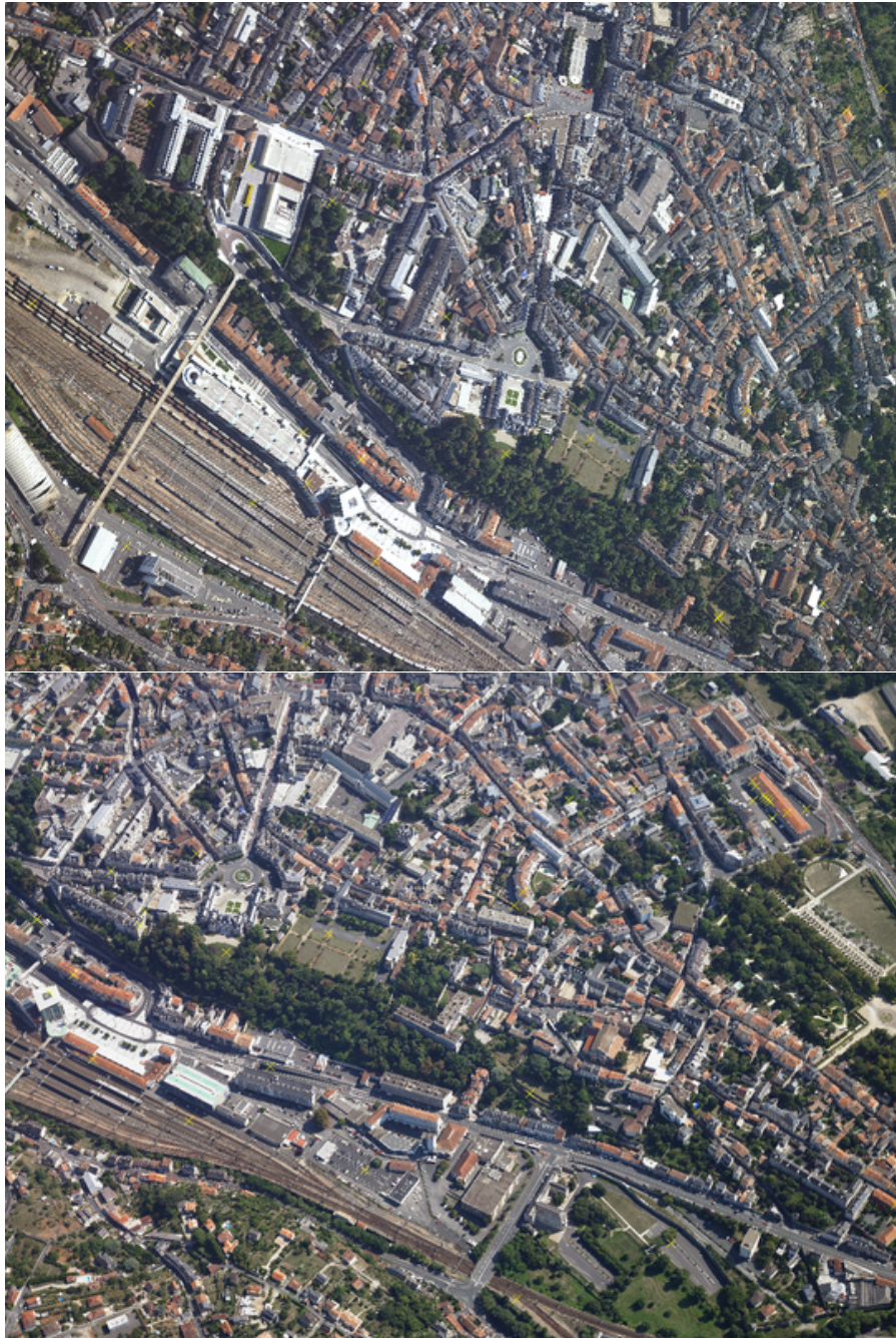
FIGURE 69 – Aucun appariement correct entre ces deux images : le changement de point de vue “3D” est trop important
