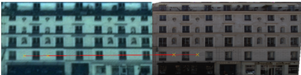
FIGURE 104 – Appariements obtenus après redressement des images
