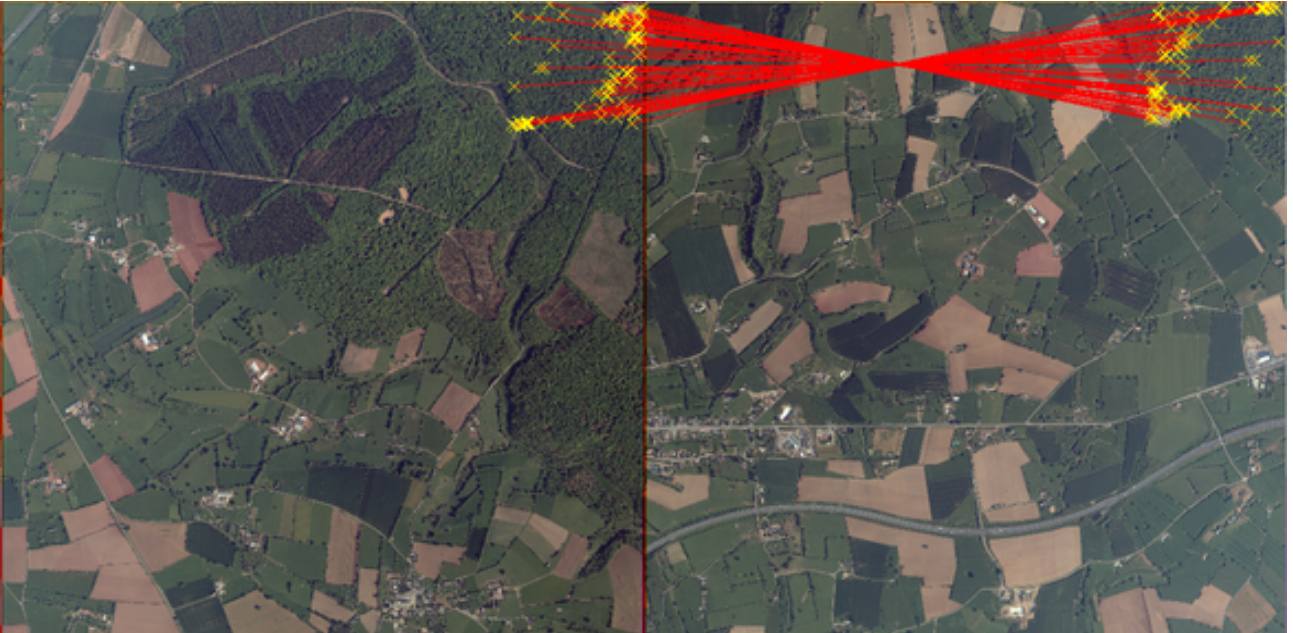
FIGURE 60 – Exemple d'appariements entre deux images en interbande pour un faible recouvrement
