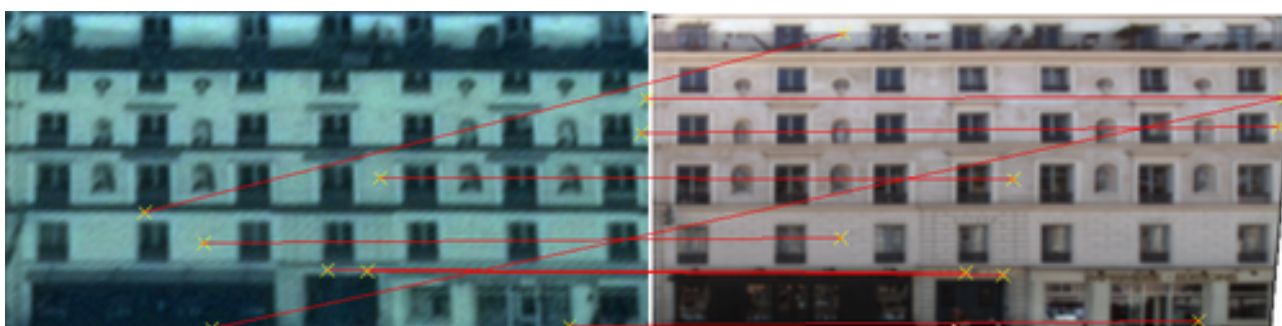
FIGURE 105 – Appariements obtenus après redressement des images et en floutant l'image la mieux résolue
