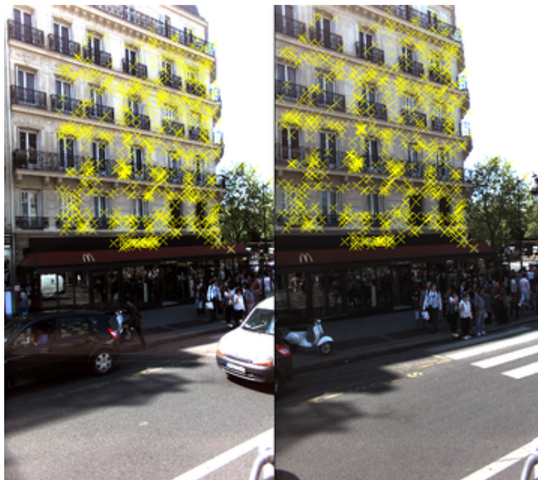
FIGURE 109 – Entre deux images consécutives (clichés n et n + 1 ), l'appariement se passe généralement bien.
