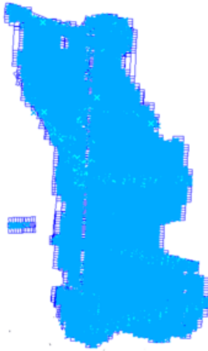
FIGURE 50 – Absence de points de liaison entre deux bandes
