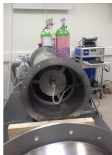
Figure 49 : Photographie de la boucle dynamique avec le module photocatalytique de l'épurateur intégré dans la partie réacteur
