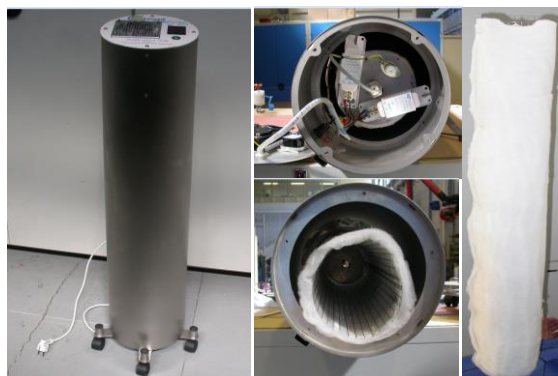
Figure 46 : Photographies de l'épurateur et des différentes parties composant l'épurateur
