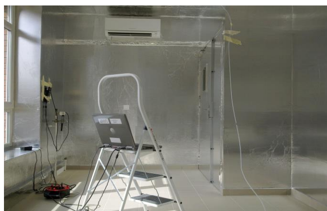
Figure 9 : Photographie de l'intérieur de la chambre expérimentale IRINA, les parois sont revêtues de feuilles d'aluminium
