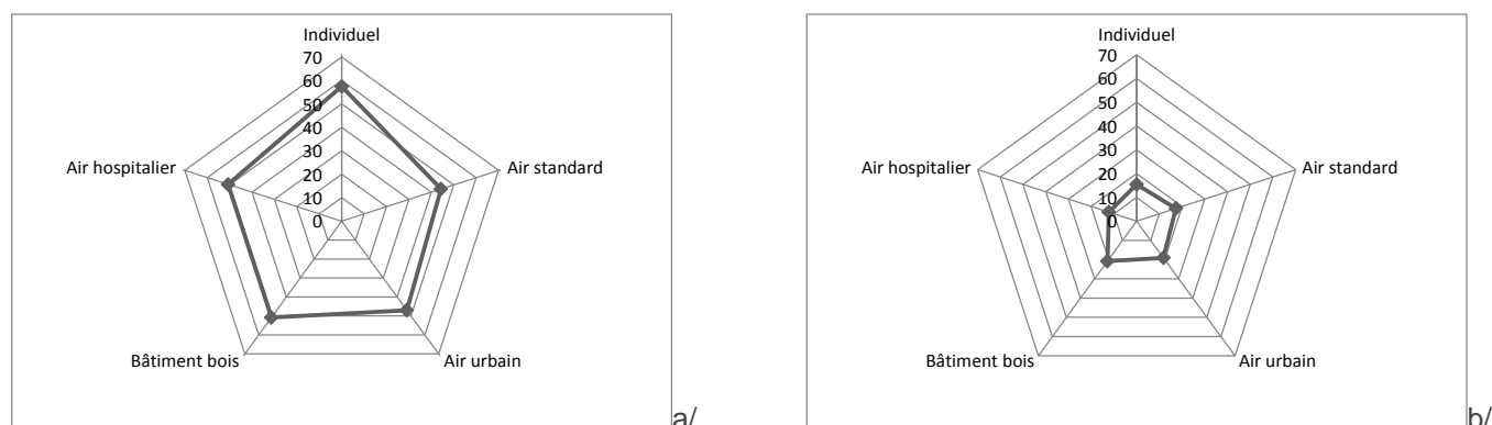
Figure 40 : Comparaisons des valeurs de CADR (m 3 /h) du toluène lorsque ce COV est traité seul (Individuel) ou au sein de chacune des quatre matrices modèles : a/ par le système UVGermi et b/ par le système AirSûr
