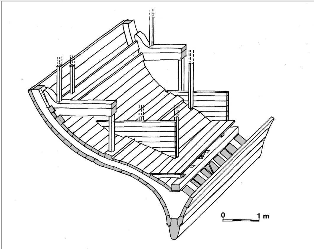
Figure 9 – Vue axonométrique de la soute à poudre
