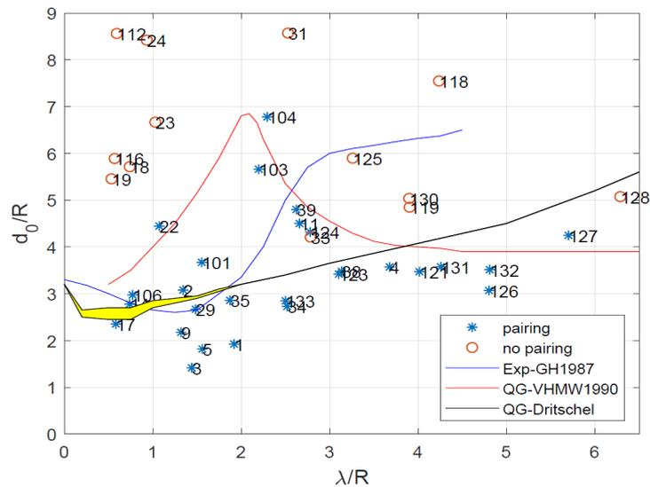
Figure 2: Diagramme d'existence des deux états (\* appariement ; o pas d'appariement) qui montre la frontière séparant les conditions qui permettent ou non l'appariement de deux anticyclones lenticulaires dans l'espace  $d_0/R$  et  $\lambda/R$ , où  $d_0$  est la distance initiale de séparation des deux vortex de rayon  $R$  dans un milieu caractérisé par un rayon de déformation de Rossby  $\lambda$ .
