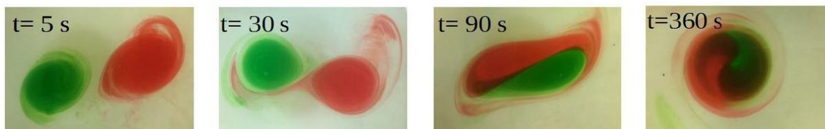
Figure 1: S  quence temporelle de la fusion d'une paire d'anticyclones pour une fr  quence de Coriolis  $f = 1.57 \text{ rad / s}$ , une fr  quence de flottabilit    $N = 3.3 \text{ rad / s}$  et une s  paration initiale  $d_0 = 8 \text{ cm}$ .
