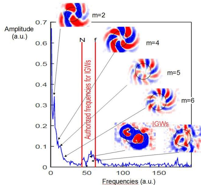
Figure 3: Spectre temporel de Fourier en un point du domaine de vitesse de la PIV et structures spatiales des modes correspondants impliqués lors de l'appariement de vortex avec des instantanés des ondes de gravité internes (IGWs) émises dans leur bande spectrale autorisée.
