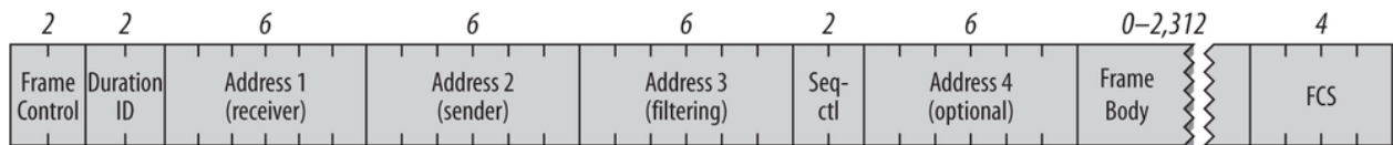
FIG. 12 : Structure d'une trame IEEE 802.11, [Gas09]
