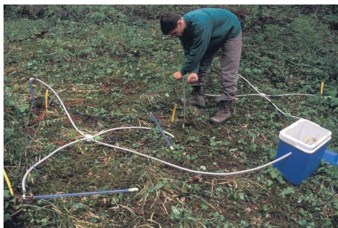
Installation du dispositif de recueil des solutions de sol (bougies poreuses)
