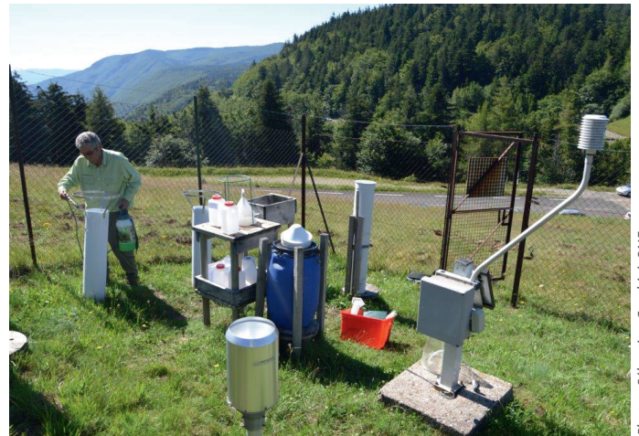
Placette du sous-réseau CATAENAT (Aigoual, HET30) pour la mesure des dépôts hors couvert
