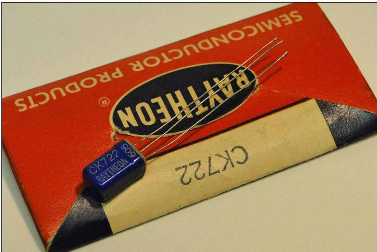
الصورة (10): ترانزستور من العائلة CK722 مصنوع في شركة رايثون، مع غلاف المنتج التجاري.
