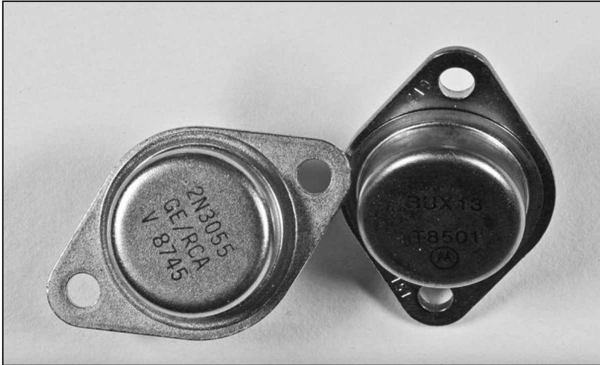
الصورة (9): ترانزستور NPN سيليكوني من العائلة 2N3055، يُستعمل لتضخيم الاستطاعة.
