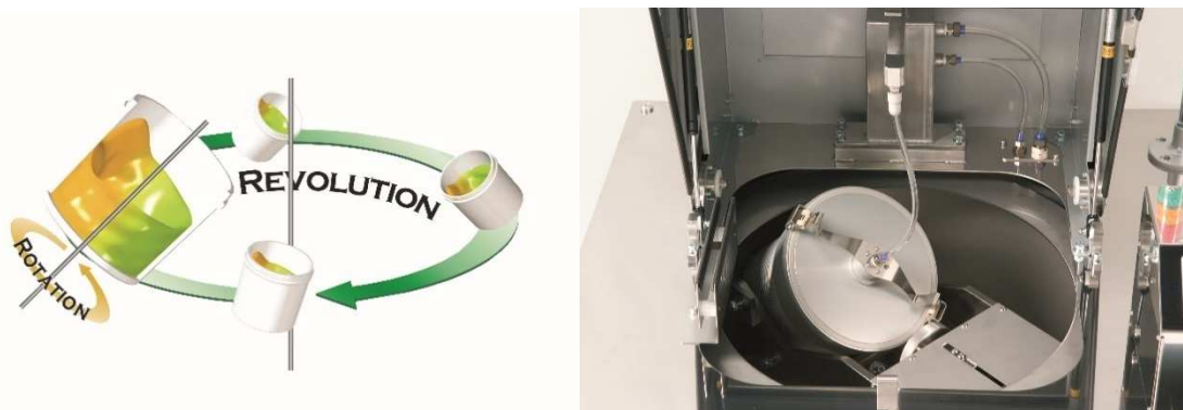
Figure 17 - Principe de fonctionnement d'un mélangeur planétaire et photographie d'un modèle commercial (provenance des illustrations [38]).
