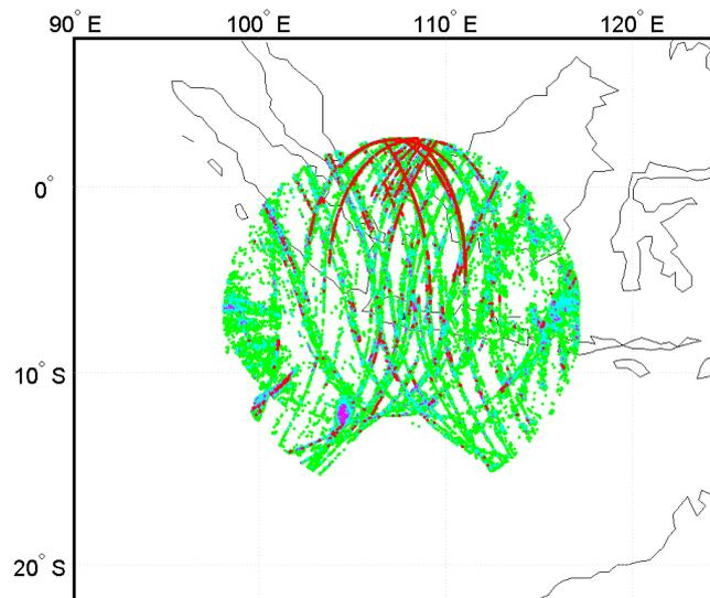
**Figure 7.** Origine géographique des scintillations observées à la station de Bandung lors d'évènements de scintillations équatoriales. Le code de couleur correspond aux intensités des scintillations observées, des plus faibles (en vert), au plus fortes (en rouge).
