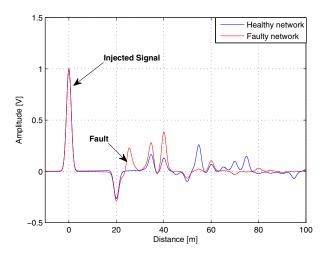
Fig. 2. Reflectogram using TDR method.
