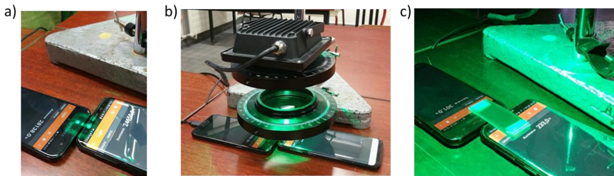
Figure 1 : a) image des LEDs vertes de la source sur les capteurs de lumière des smartphones b) Polariseur et analyseur pour l'étude de la linéarité des capteurs c) transparents verts sur les capteurs, éclairage en lumière verte.
