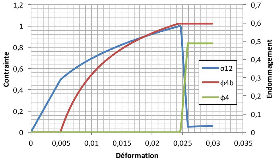
Fig. 1. Comportement avec endommagement diffus en cisaillement
