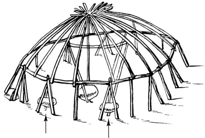
Fig. 38 – Armature de tente tchoukchi tenue au sol par des pierres apparemment suspendues (dessin extrait de Gessain, 1981)
