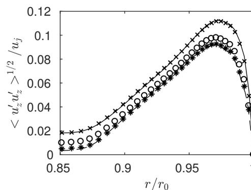
FIGURE 2 – Profil radial d'intensité turbulente axiale  $\langle u'_z u'_z \rangle^{1/2} / u_j$  en sortie de buse : —  $d = 0$ ,  $\times$   $d = 2r_0$ ,  $\circ$   $d = 3r_0$ ,  $*$   $d = 4.4r_0$ , - - - jet libre [3].
