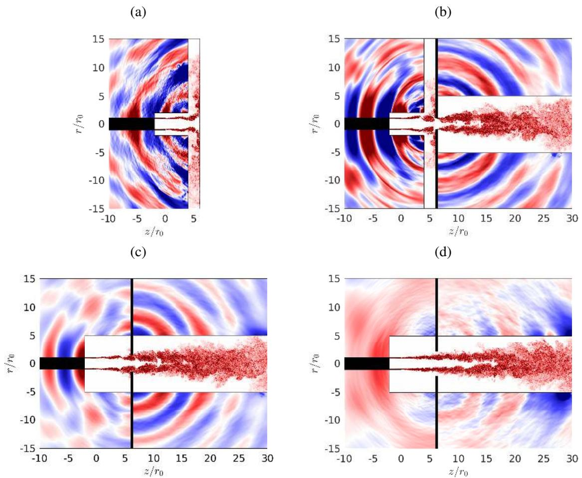
FIGURE 1 – Représentation des champs de vorticité à l’intérieur de l’écoulement et de pression fluctuante à l’extérieur pour quatre diamètres du trou : (a)  $d = 0$ , (b)  $d = 2r_0$ , (c)  $d = 3r_0$ , (d)  $d = 4.4r_0$ . L’échelle de couleur va de 0 à  $7u_e/r_0$  pour la vorticité et (a), (b), (c) de -1000 à 1000 Pa ou (d) de -500 à 500 Pa (d) pour la pression.
