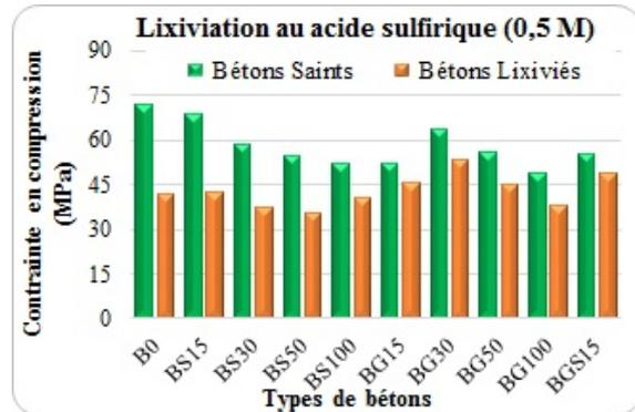
Figure 4. Evaluation de la résistance en compression après attaque sulfurique après 28 jours
