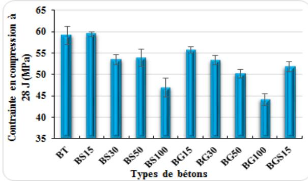
Figure 1. Evaluation des résistances caractéristiques des différents bétons
