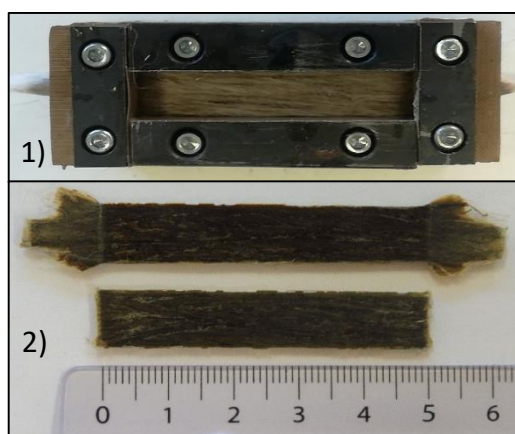
Figure 4 : Préparation des éprouvettes de composite 1) Moule avec mèches de chanvre alignées et fixées 2) Eprouvettes de composites
