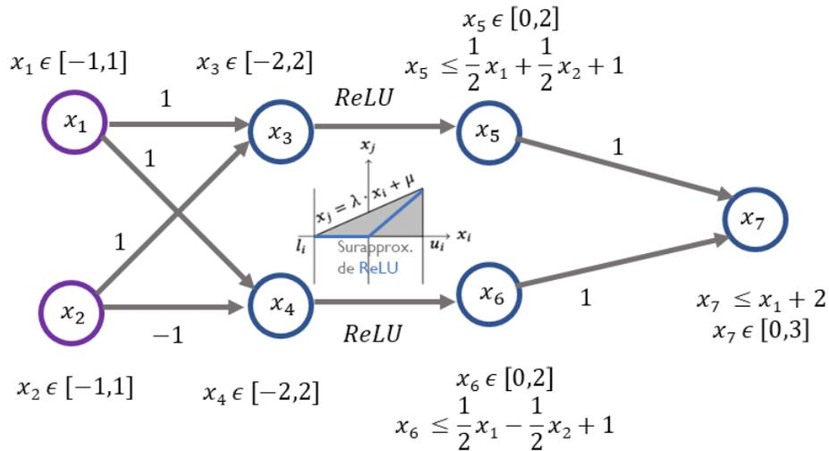
FIGURE 3: Zonotope utilisé dans ERAN : La fonction ReLU est surapproximée par une fonction linéaire. Cela permet d'être sûr que  $x_7 \leq 3$ , ce qui ne serait pas le cas si on ne considère que les valeurs extrémales ( $x_7 = 4$  semblerait possible).
