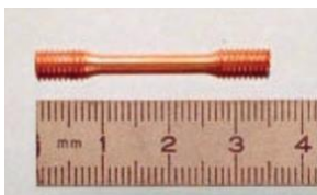
Figure 7 – a) Une éprouvette de traction en cuivre, instrument de mesure des propriétés thermoplastiques d'un matériau, ici son élasticité ; b)
