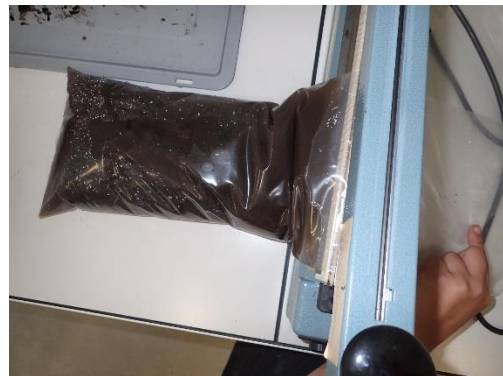
Thermosoudage des gaines.
