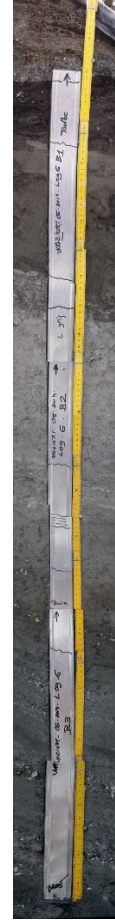
Figure 96 : Log 6, colonne palynologique avant extraction de la coupe. Vue panoramique, assemblage de plusieurs photos.
