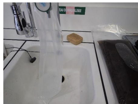
Remplissage des gaines thermosoudées en eau déminéralisée.
