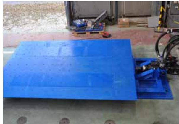
Les laboratoires 3SR et AE&CC ont développé une table vibrante permettant de tester différents détails constructifs à échelle 1.
