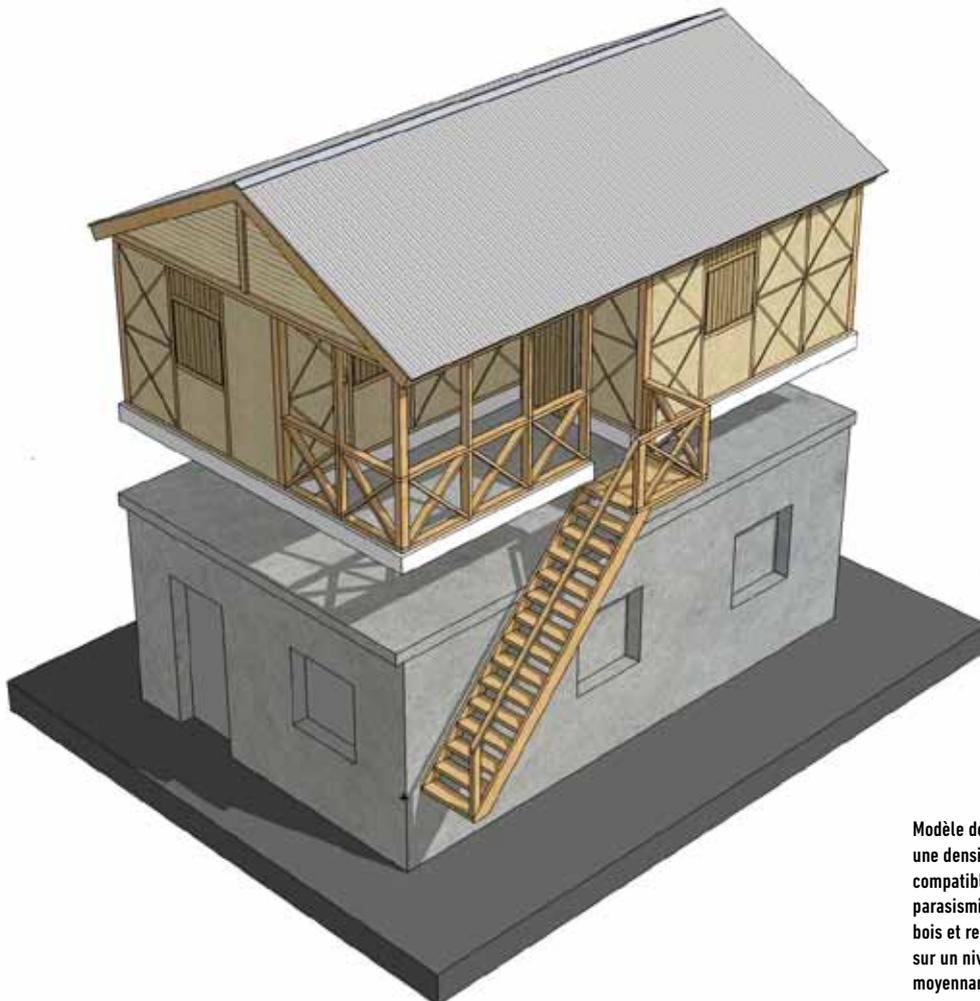
Modèle de surélévation permettant une densification de l'habitat compatible avec les règles de l'art parasismiques. Un étage en ossature bois et remplissage peut être ancré sur un niveau existant en maçonnerie, moyennant un renforcement éventuel.
