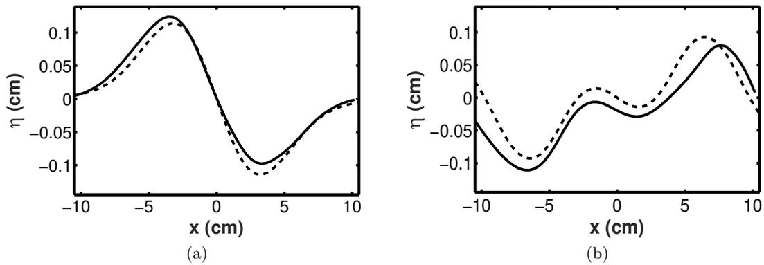
**FIGURE 1.** Profil de la surface libre  $\eta$  en fonction de  $x$  sur la ligne qui passe par le centre des plaques . (a)  $t = 0,093$  s et (b)  $t = 0,91$  s. Solution de la théorie linéaire (—) et résultat expérimental (ligne continue). La théorie linéaire a un bon accord avec les données expérimentales pour  $t = 0,093$  s. Pour  $t = 0,31$  s, il y a une certaine différence entre les deux.
