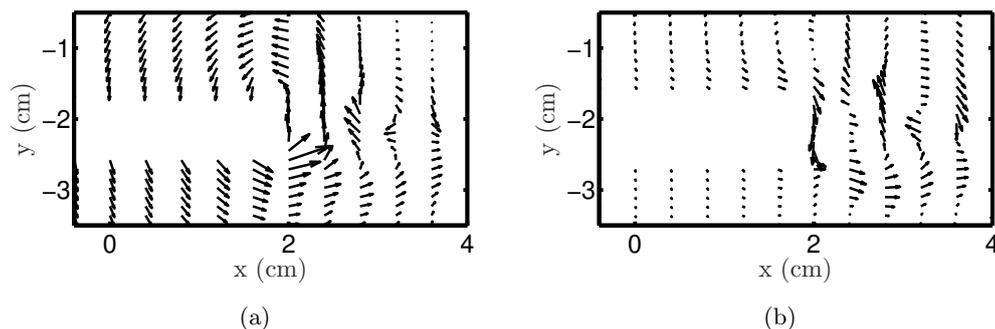
**FIGURE 4.** Champ de vitesse qui résulte de résoudre les équations de Navier–Stokes et de continuité avec Gerris. (a)  $t = 9,1$  s et (b)  $t = 8,6$  s. Dans la simulation on utilise de l’eau comme liquide et il y a de l’air au-dessus de la surface libre. Le batteur se trouve dans la région où il n’y a pas des vecteurs de vitesse et son bord droit se trouve à  $x = 2$  cm. Dans ce cas on obtient que la valeur moyenne de la composante horizontale de la vitesse est non nulle.
