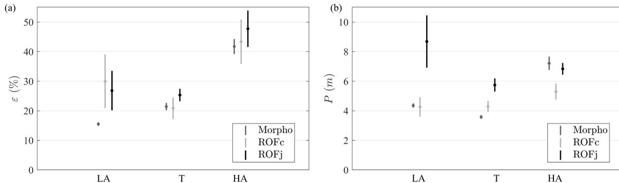
**FIGURE 3.** Valeurs moyennes et écarts-types obtenus avec les trois algorithmes de traitement d'images pour les différents régimes d'écoulement : (a) fraction totale de gaz,  $\varepsilon$ ; (b) périmètre total des bulles par image,  $P$ .
