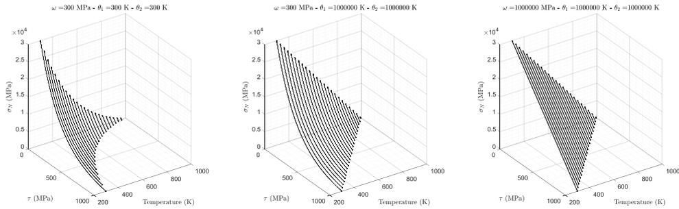
**Figure 1 Effet des paramètres  $\omega$ ,  $\theta_1$  et  $\theta_2$  sur la courbure de la surface seuil**
