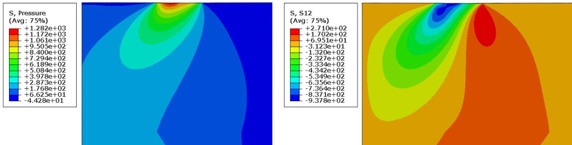
Figure 5 Champs de pression hydrostatique (à gauche) et de cisaillement  $\tau$  (à droite) avec un coefficient de frottement de 0.5 (contraintes exprimées en MPa)
