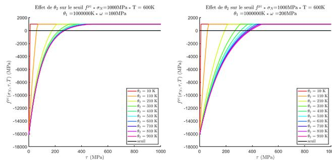
**Figure 3 Effet du paramètre  $\theta_2$  sur le seuil  $f^{pz}$  avec une contrainte  $\sigma_N$  de 1 GPa à T=600 K :  $\omega = 100$  MPa (à gauche) et  $\omega = 200$  MPa (à droite)**
