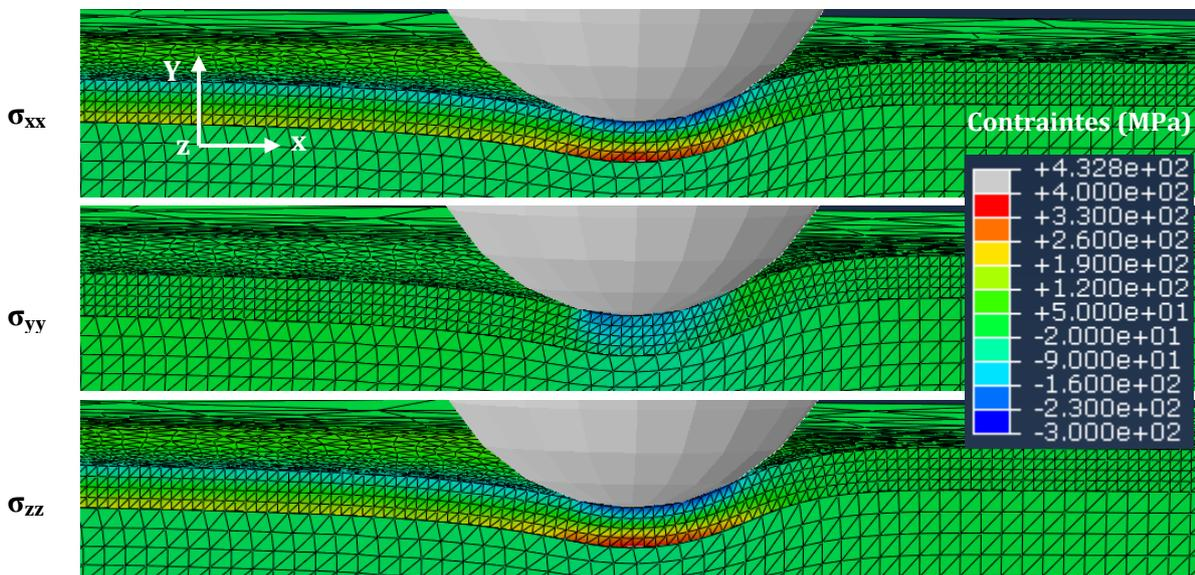
Figure 6 : Contraintes  $\sigma_{xx}$ ,  $\sigma_{yy}$  et  $\sigma_{zz}$ .  $F_n = 1 \text{ N}$ . Sens de rayure : de gauche à droite
