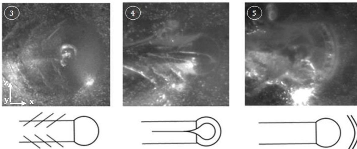
Figure 2 : Photographies in situ et schémas des différents modes de rupture observés sur la figure 1
