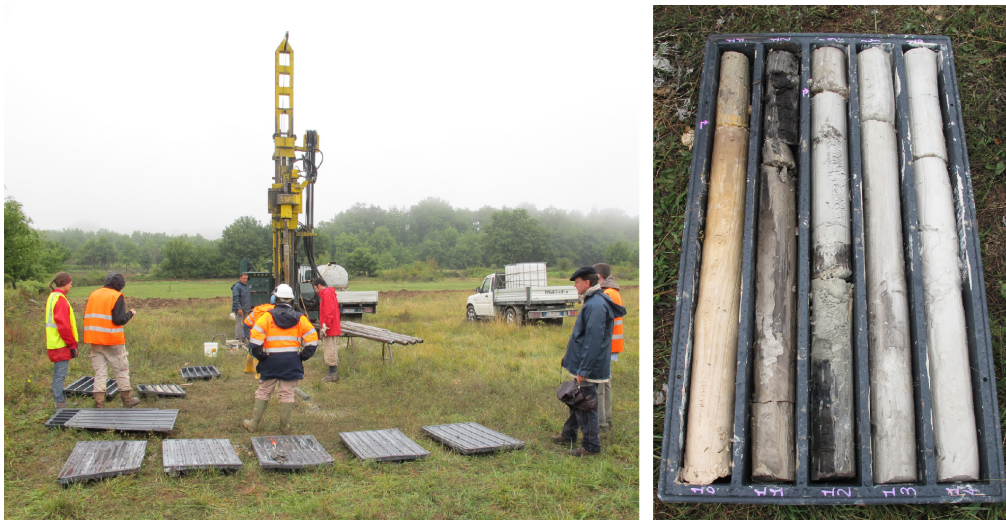
Fig. 4 - Réalisation du carottage mécanique à Valle Giumentina et cinq mètres de la carotte.
