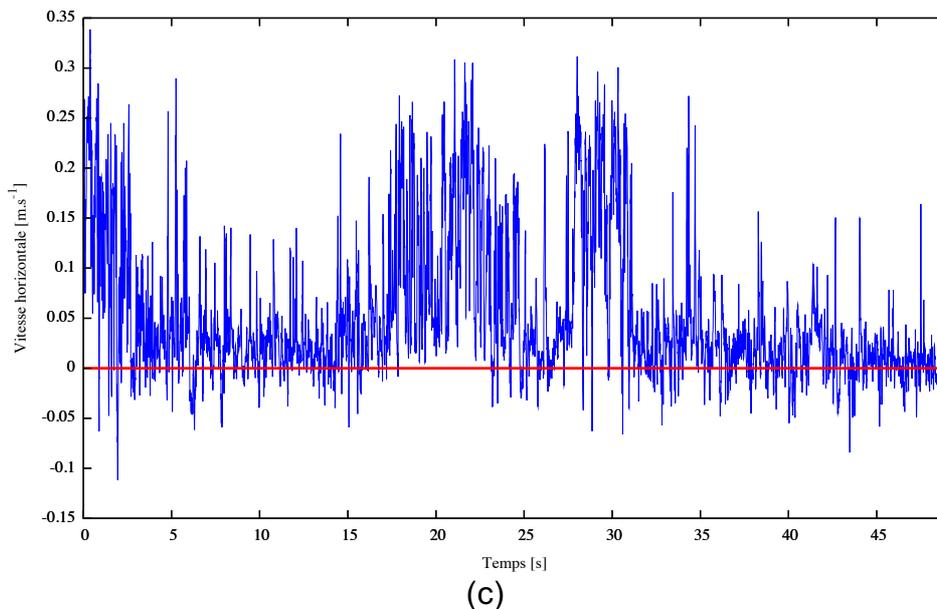
**Figure 7 – Suivi temporel de la vitesse horizontale [m.s<sup>-1</sup>]: pour une ouverture H de 500 mm - y/L = 0.006 (a), pour une ouverture H de 350 mm - y/L = 0.006 (b) et y/L = 0.48 (c).**
