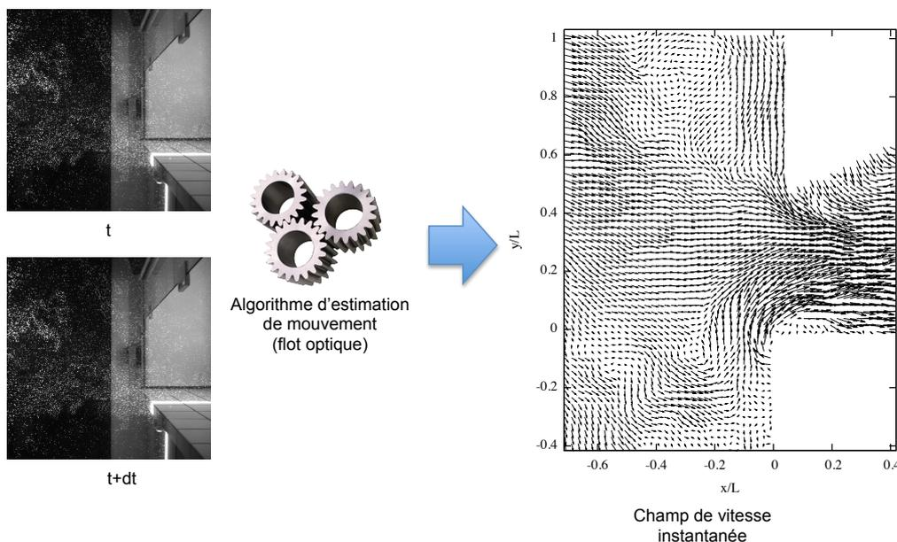
**Figure 3 – Schéma récapitulatif du fonctionnement de la méthode.**
